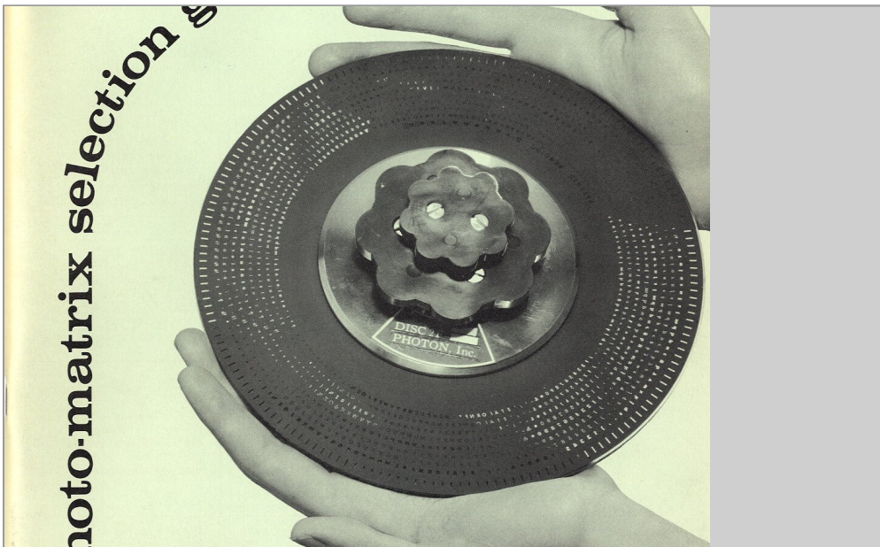
Fig. 21 – Disque typographique pour la photocomposition avec les caractères en négatif
