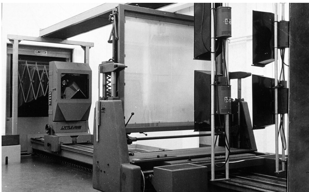
Fig. 24 – Dispositif photographique pour « flasher » les pages une fois composées et imposées
